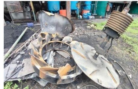
Gambar 2. Kondisi *Impeller*, *Pulley House*, dan *Snap Impeller*
