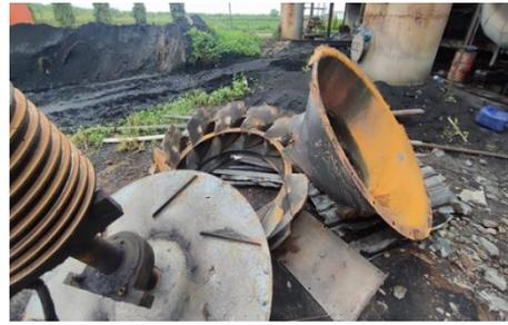
Gambar 1. *Impeller* dan *Conecting* setelah mengalami kerusakan
