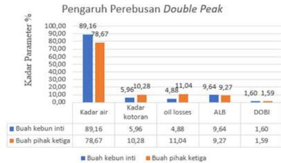
**Gambar 2** Data kadar air, kadar kotoran, ALB dan DOBI
