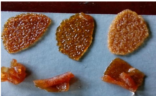
Gambar 1. Sampel lateks menjadi cokelat dan lengket akibat oksidasi suhu tinggi
