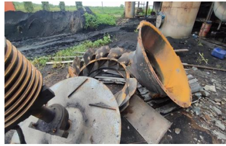
Gambar 1. Impeller dan Conecting setelah mengalami kerusakan
