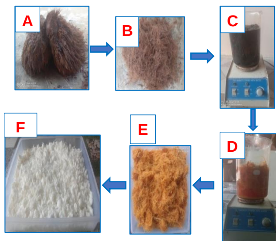
Gambar 1 : Skematik proses pulping dari TKKS : A. TKKS, B. Serat TKKS, C. Proses Hidrolisis Asam dari TKKS, D. Proses Hidrolisis Basa dari TKKS, E. Serat hasil hidrolisis Basa, F. Pulp dari TKKS yang telah di bleaching
